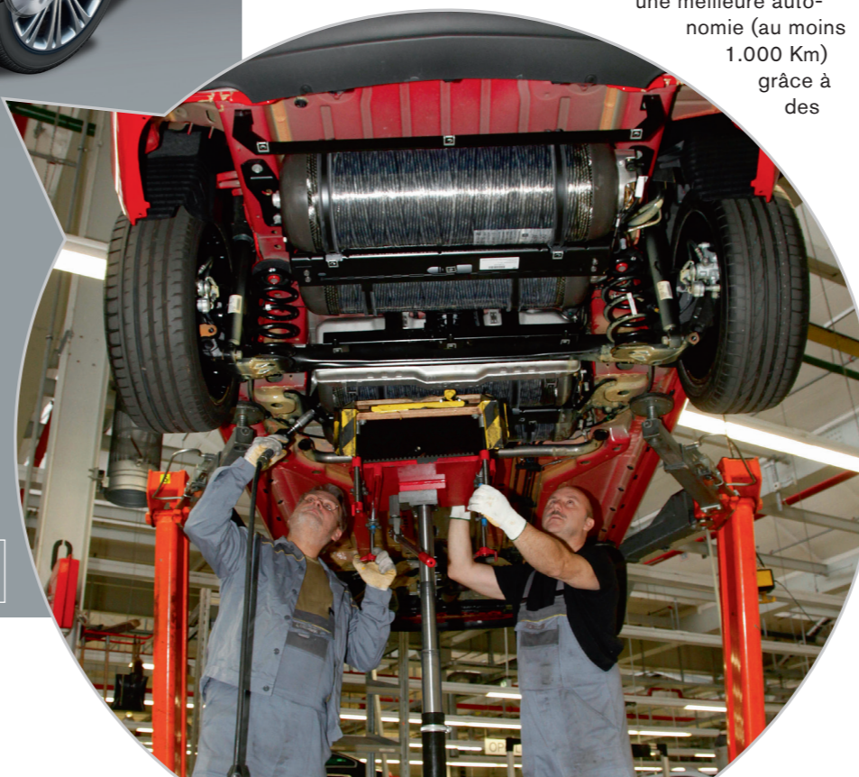
Montage en usine chez Opel de bonbonnes de gaz naturel
